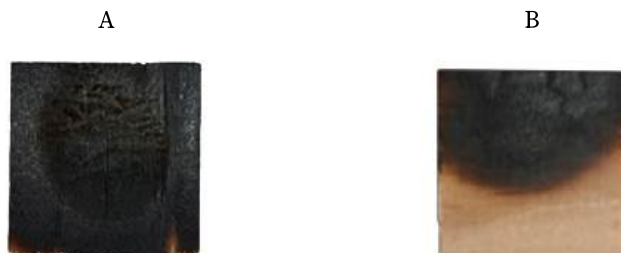
Figura 4.24 – Muestras de madera de pino radiata sometidas a pruebas experimentales de resistencia al fuego, A) muestra control y B) muestras tratadas con soluciones experimentales en base a boro y nanopartículas modificadas (P Fondef ID25110258)
