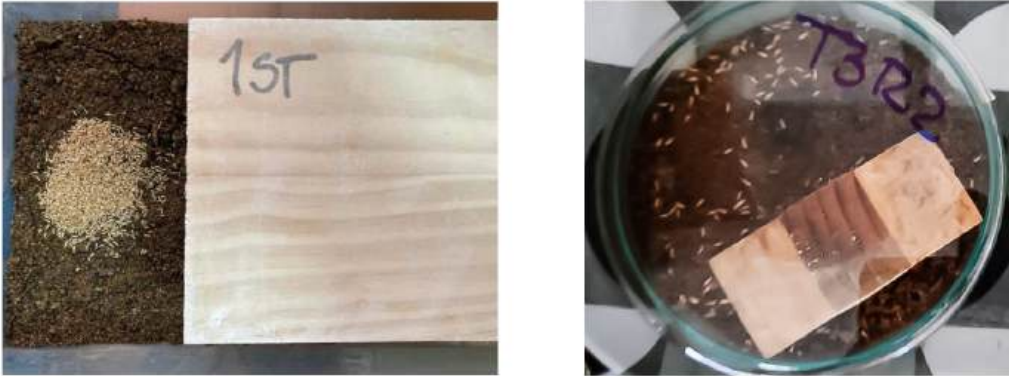
Figura 3.16 – Instalación de probetas para ensayo frente a termitas
