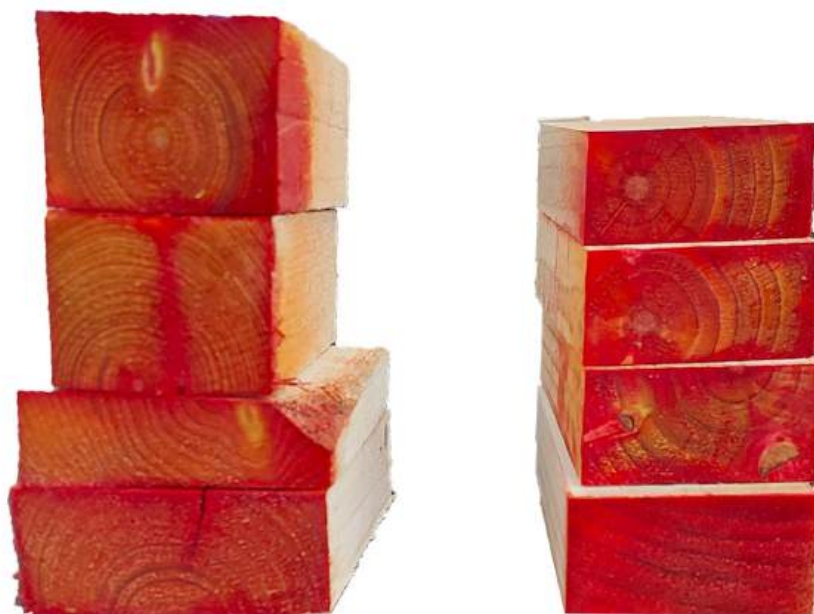
Figura 4.5 -Penetración tratamiento CA-B
