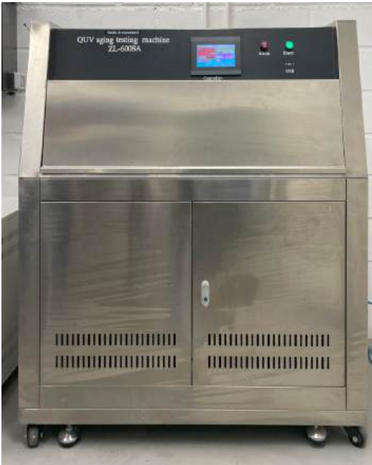
Figura 3.9 – Cámara de envejecimiento acelerado para analizar la durabilidad en laboratorio
