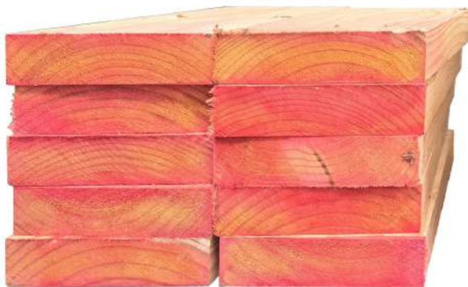
Figura 4.10 - Penetración tratamiento LOSP (Vacsol® Azure (RTU)) mediante Impregnación Método Vacío –Vacío. En la se presentan piezas de madera lateral y semilateral
