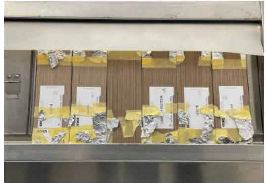
Figura 3.10 – Probetas en máquina de envejecimiento acelerado
