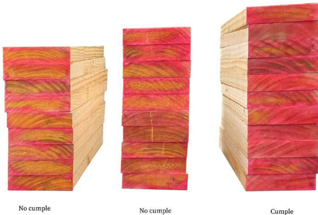
Figura 3.7 – Ensayo penetración mediante colorimetría. Tratamiento de impregnación con LOSP (Vacsol® Azure (RTU) mediante Vacío – Vacío de piezas de madera lateral
